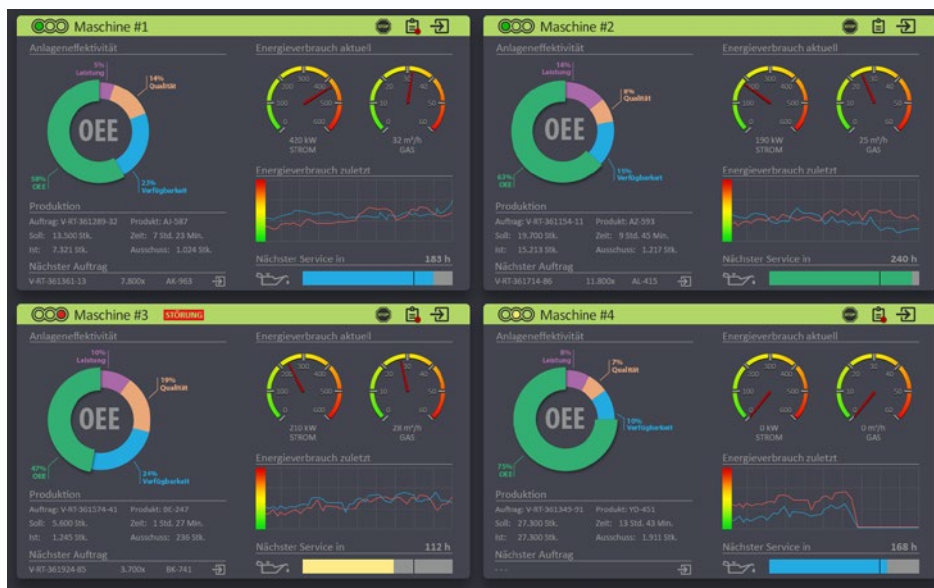
In einer Shopfloor-Ansicht können die Betriebs- und Servicedaten von mehreren Maschinen angezeigt werden.
