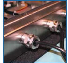
Kabelverschraubung aus Edelstahl an der Unterseite
