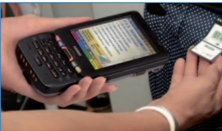
Als erster Industrie-PDA mit dem Betriebssystem Windows® Mobile 6.5 und mit Wireless WAN 3.5G, WLAN sowie Bluetooth® ist der IT-800 extrem flexibel einsetzbar. Neben der rasanten Datenkommunikation bietet das Terminal auch Telefonfunktionalität und kann damit das Mobiltelefon vollständig ersetzen. Zu den weiteren Features gehören GPS zur Positionsbestimmung, eine Kamera mit Autofokus und Blitz zur schnellen Bilddokumentation sowie ein Laserscanner oder CMOS-Imager für 1D- und 2D-Codes.
