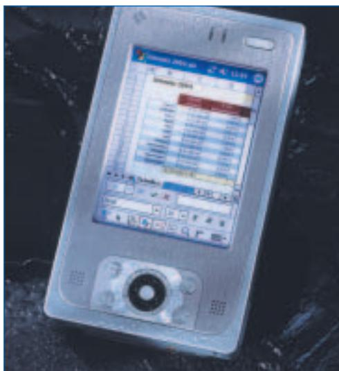
zuverlässig vor Schlägen und Erschütterungen. Das kontrastreiche Display lässt sich immer exzellent ablesen – bei Dunkelheit oder gleißendem Sonnenlicht. Es ist in einen gummigelagerten, stoßabsorbierenden Rahmen eingefasst. Staub- und Wasserschutz nach IP54 (IEC60529-Standard) ermöglicht den problemlosen Einsatz bei jeder Witterung.
