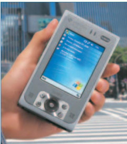
Der IT-10 überzeugt auf den ersten Blick mit seinem 3,7 Zoll großen transflektiven TFT-Farb-LCD. Es bietet hochwertigen VGA-Standard (640 x 480) und liefert im Vergleich zu normalen 1/4-VGA Displays eine vierfach höhere Auflösung. Damit ist das Gerät auch zur Darstellung feiner Bilddetails sowie für web-basierte Inhalte bestens geeignet. Das Display zeigt aber auch herkömmliche 1/4-VGA Applikationen an, so dass sich bestehende, ältere Softwarelösungen weiterhin nutzen lassen.
